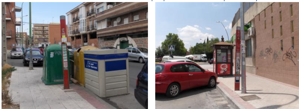
Ilustración 46.- Problemas accesibilidad por presencia mobiliario: paradas 33 y 79
