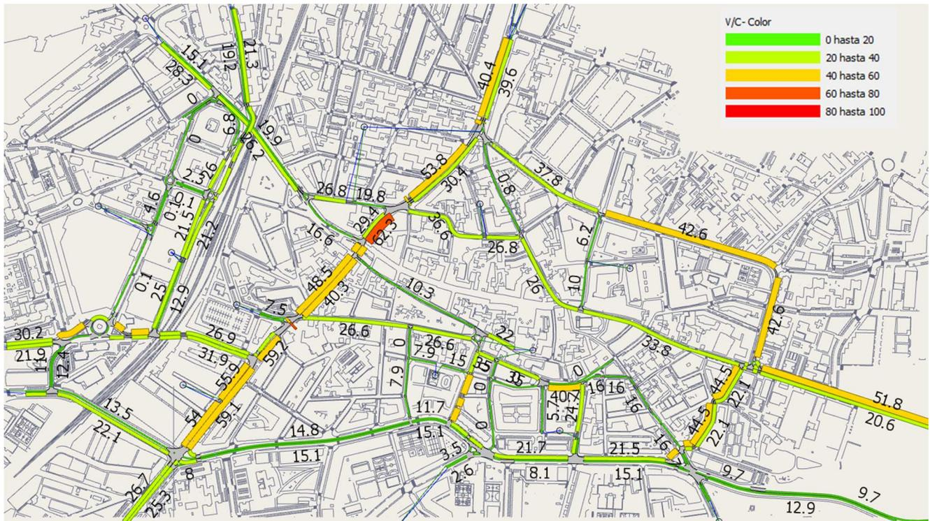
Ilustración 29: Grado de saturación de la red viaria (Intensidad/Capacidad) Fuente: DOYMO.
